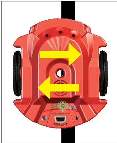
Stelle den S2 auf das Papier und bewege ihn vor- und rückwärts über die schwarze Linie. Wenn der rechte Sensor die Linie sieht, wird die grüne LED rechts leuchten. Wenn der linke Sensor die Linie sieht, leuchtet die grüne LED links auf. Erkennen beide Sensoren die Linie, leuchten beide grünen LEDs auf. Die LEDs leuchten rot, wenn keine Linie detektiert wurde.
