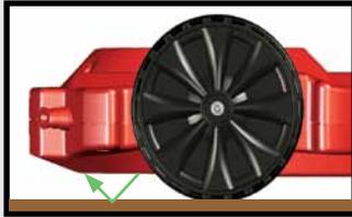
Der S2 hat zwei Paare Infrarot-Sender und Empfänger an der Unterseite. Mit diesen erkennt er schwarze Linien auf weissem Papier.
