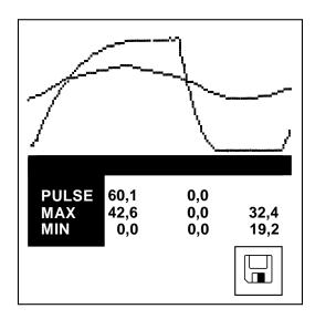
Am Bildende des Vakuumverlaufes wird am Kanal 1 die Pulsfrequenz und an allen angeschlossenen Messkanälen das Maximum und Minimum ermittelt.
