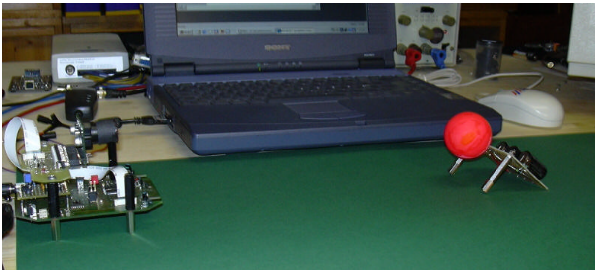
Bild 6 Reales Szenario zur Objektdetektion. Ein MauSI-Skelet (links) versucht das Ziel, den roten Tischtennisball zu lokalisieren.
