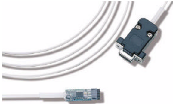
Bild 1: SX-Key Programmiergerät und Emulator
