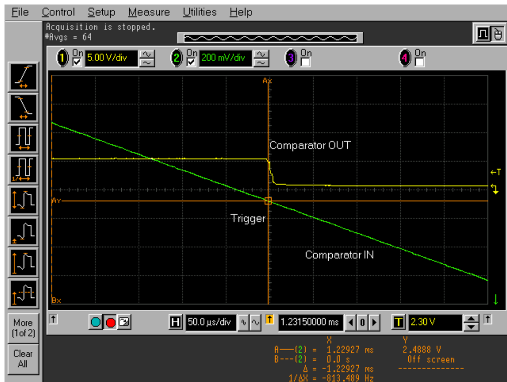
Bild 10: Kennlinie eines digitalen CMOS-Inputs bei linear abfallender Eingangsspannung
